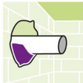
Voor het vullen van leidingdoorvoeren.
